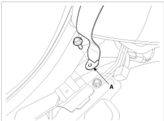
3. 分离连接器 (B) 后，拧下固定螺栓，拆卸前座椅安全带卷带器 (A)。
